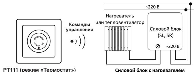
Рисунок 3. Использование датчика PT111 в качестве термостата
